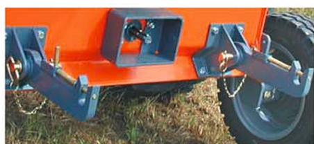
Jūgvārpstas piedziņa. Apakšējo vilcējstieņu stiprinājums trīspunktu ierīces pievienošanai.
